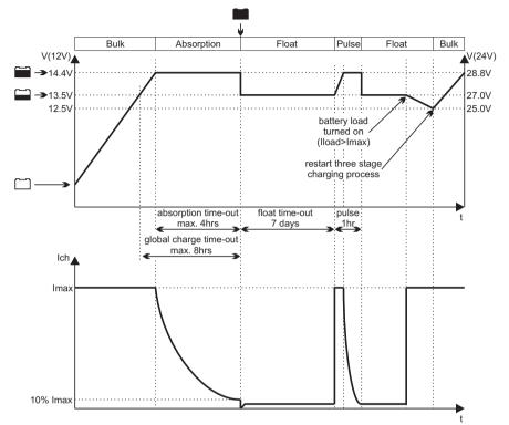
В стадии BULK 3У подает на АКБ максимальную силу тока и обычно заряжает до состояния приблизительно 80%, после чего включается режим ABSORPTION. Во время заряда BULK на индикаторе стадии заряда может показываться — или —.
